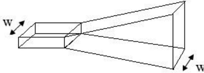
Figure 4.10.1. E-plane Horn Antenna.
