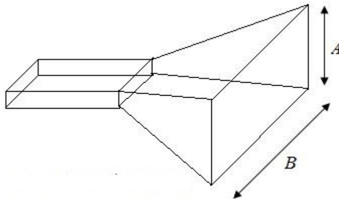
Figure 4.10.3. Pyramidal Horn Antenna.
