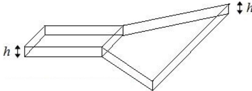
Figure 4.10.2. H-Plane Horn Antenna.
