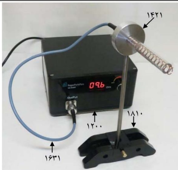
شکل ۹۷: نحوه اتصال آنتن هلیکال به مولد سیگنال مایکروویو با استفاده از کابل فرکانس بالا
